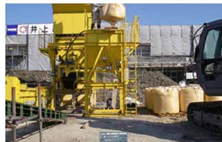
可搬式土質改良機：中性固化土工事業協同組合（複数改良資材の同時混合）
