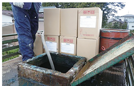
種子散布車：希釈液を作成してそのまま散布
